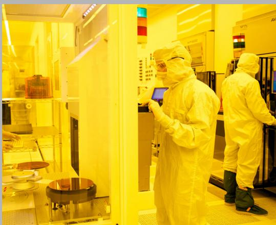
Le laboratoire MEMS du C2MI est doté de salles blanches de classe 10 et de classe 1 à la surface des tranches. L'infrastructure est adaptée autant au micro-usinage de couche de surface qu'à celui du silicium. Le C2MI est doté de lignes de production pour l'assemblage de premier niveau ainsi que la fabrication et l'encapsulation de MEMS sur des tranches de 200 mm.
