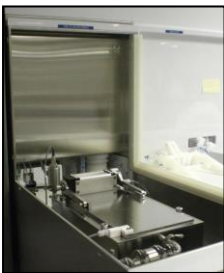
Figure 2: Image d'un module d'amorçage sous vide sur un banc humide Akrion GAMA
