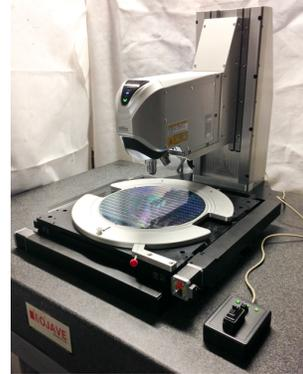
Le C2MI dispose d'un microscope confocal à balayage laser VK-X260K de Keyence qui est équipé d'un laser violet (408 nm), d'une variété d'objectifs (5x, 10x, 20x, 50x, 100x et 150x) et d'un plateau motorisé 300 mm X 300 mm.
