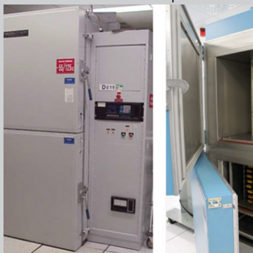
Figure 1: Équipement servant à faire du choc et cyclage thermique, courtoisie du secteur de fiabilité du C2MI
