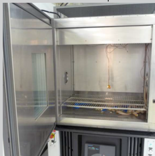
Figure 1: Équipement servant à faire du choc et cyclage thermique, courtoisie du secteur de fiabilité du C2MI
