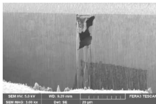
Figure 9: Observation de la coupe FIB du défaut.
